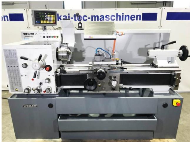
(CNC-) Drehmaschinen, Leit- und Zugspindeldrehmaschinen
